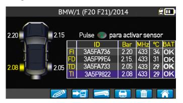
Activa y muestra la información del sensor para todos los sensores OE, así como para la mayoría de los sensores TPMS del mercado independiente, incluida la ID del sensor, la presión, la frecuencia, la temperatura y el estado de la batería.
