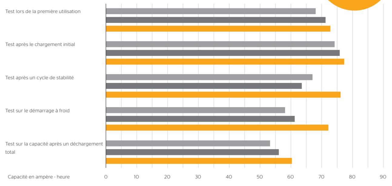
Pour les tests sur la **stabilité du cycle**, le **démarrage à froid** et la **capacité de déchargement**, les batteries Continental à technologie AGM L4 obtiennent les **meilleurs résultats**.
