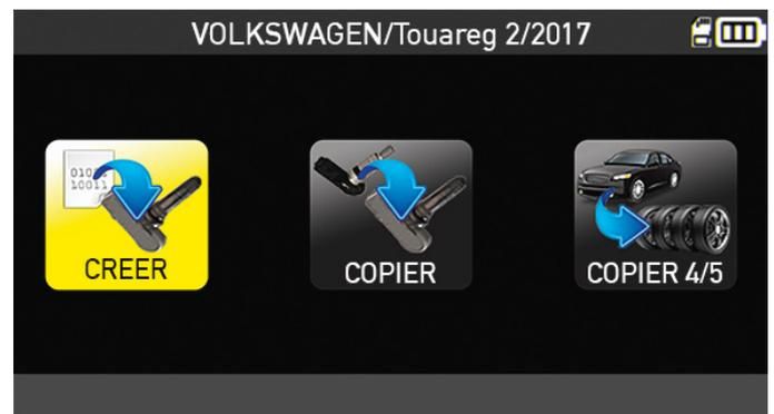
Programmation instantanée jusqu'à 5 capteurs (jeu de pneus neige par exemple). Sélection par fabricant de capteur ou par modèle de voiture et année.
