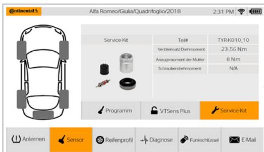
Mit der Service-Kit Funktion können die Ersatzteilnummern und Drehmomente für Sensorventile aufgerufen werden. Zusätzlich wird ein Bild des Kits angezeigt, um Fehlidentifikationen zu vermeiden.
