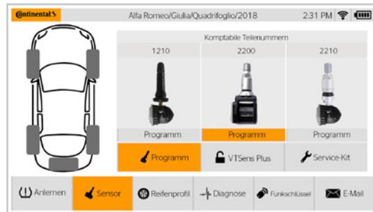
Die Programmierung von Universalsensoren lässt sich schnell erledigen. Rad für Rad - oder auch für den gesamten Reifensatz gleichzeitig, ideal für Winterräder. Anschließendes Anlernen per OBDII-Schnittstelle dauert weniger als 90 Sekunden.
