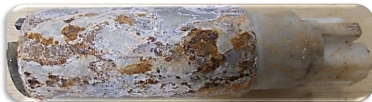
Carcaça externa da Bomba com alto nível de oxidação, devido contato com combustível incorreto (Etanol)
