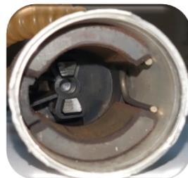
Oxidação dos componentes internos da bomba de combustível gasolina quando aplicada em um veículo movido a etanol/flex.
