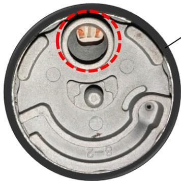
Resíduos de estopa entraram em contato com o impelidor (turbina)
