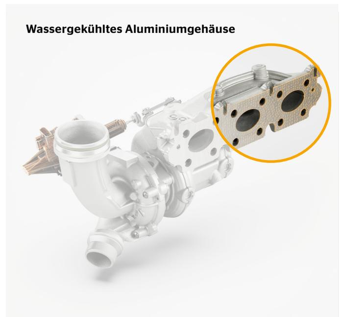
Die Wasserkühlung ermöglicht den Einsatz des Leichtbauwerkstoffs Aluminium und macht das Turbinengehäuse fast 30 % leichter und wesentlich langlebiger.
