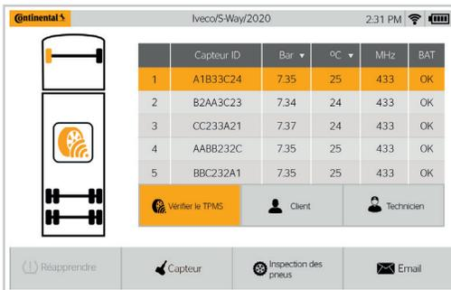
La vue Véhicule permet d'extraire les données des capteurs et saisit les informations clients directement sur le camion. De plus, toutes les informations sur les capteurs telles que ID du capteur, pression, fréquence et température sont affichées et peuvent être sauvegardées sous forme de rapport.
