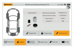
La fonction Kit de service pour capteurs permet de consulter les références des pièces de rechange et les couples de rotation des valves à capteur. Une représentation du kit est en outre affichée pour éviter fiablement les erreurs d'identification.
