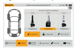
La programmation des capteurs universels se fait rapidement : roue après roue, ou encore pour le jeu complet de pneus, ce qui est très pratique pour les pneus d'hiver. L'apprentissage effectué ensuite par l'interface OBDII dure moins de 90 secondes.
